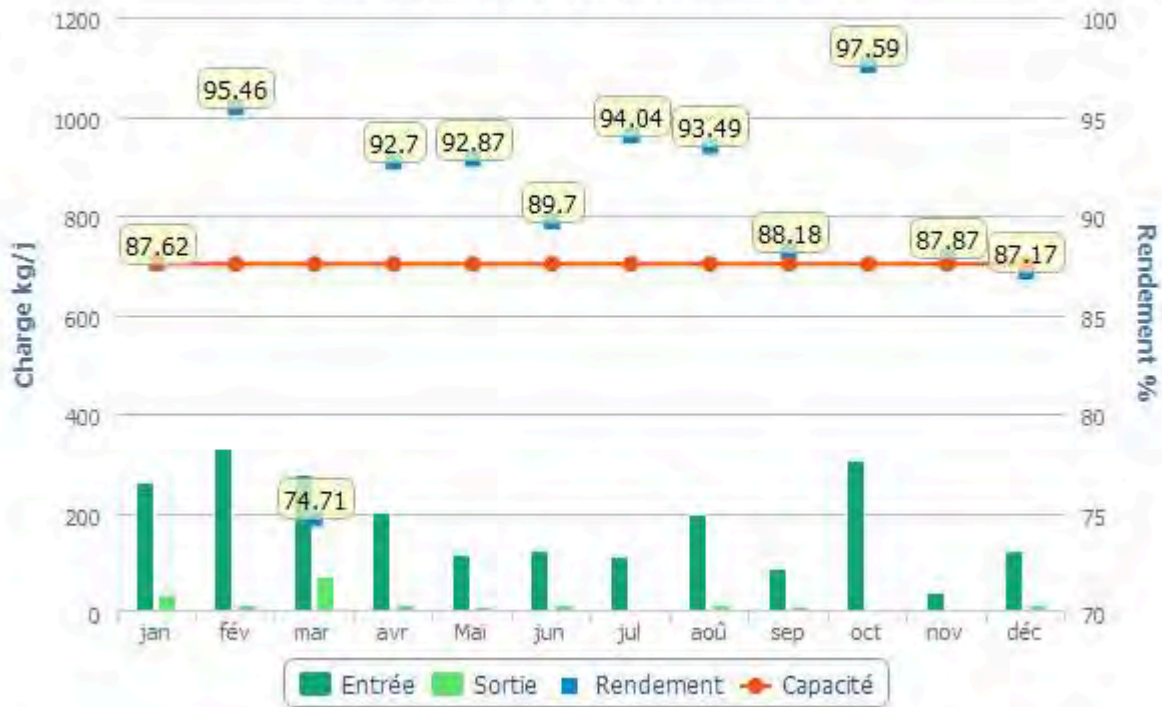
Evolution des charges et du rendement DBO5
